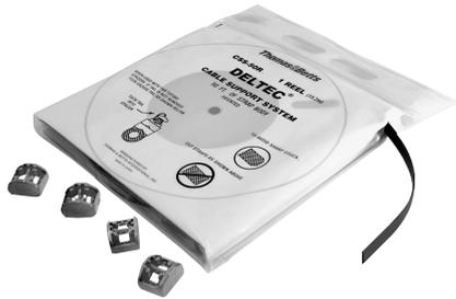
デルテックケーブルサポートシステムは任意にカットができ、屋内外の電線、電話ケーブルなどの結束に最適で、簡単な作業で、確実なケーブルサポートを実現します。紫外線、水分、カビ、薬品等に耐える化学的特性を持ったアセタール樹脂（一般素材名）の採用により、荷重および摩擦に対する物理的耐性を生み出しています。またストラップ内側の2本のグリップラインにより、確実な支持力が得られます。
